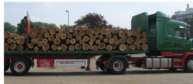
2. Auf den Fahrzeugböden müssen im Ladebereich in Längsrichtung zwei Keil- bzw. Stegleisten vorhanden sein. Diese müssen so beschaffen sein, dass sie die untere Stammlage formschlüssig sichern.
